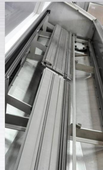
La optimización del tiempo y de la prestación es uno de nuestros principales objetivos. Por eso H2G está equipada con un sistema capaz de medir automáticamente el perfil de la placa de agujas y de personalizar el ciclo de lavado en función de sus dimensiones.
